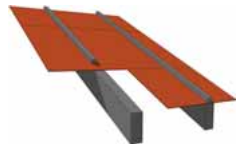
Dachaufbau mit Unterspannung ohne durchströmungshemmende Schicht
