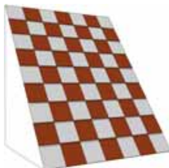
Befestigungsschema 1:2 – jeder zweite Dachstein
